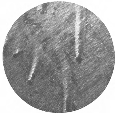
Fig. IV. Stuk van een rond gebogen plaatje waarop het begin van de aantasting goed te zien is en ook de kromming van de kanaaltjes (links).
